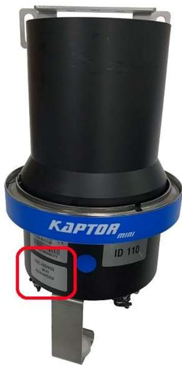
Ogni strumento possiede un identificativo univoco composto da una sequenza alfanumerica di 12 caratteri (numeri da 0 a 9 e lettere da A ad F) riportato su di una etichetta apposta all'esterno del case.
