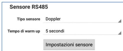
**Tipo sensore:** scegliere il tipo di sensore collegato (Doppler o TTFM) e premere su “Impostazioni sensore” per la configurazione completa.
