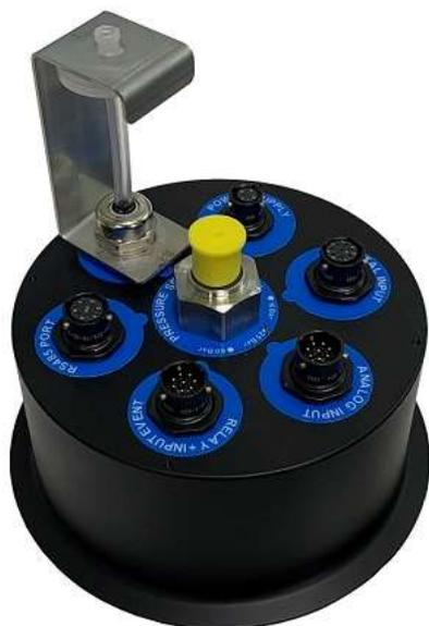
Tutti i connettori, disposti sul lato basso del **KAPTOR MINI**, sono appositamente di dimensioni o polarità diverse tra loro in modo di facilitare l'utente al loro corretto cablaggio, questo accorgimento impedisce il collegamento di sensori/periferiche in ingressi non corretti.
